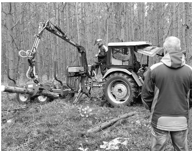
Holzrückung mit Traktor und Ruckeanhänger im Privatwald (Foto: FBG Großenhainer Land w.V.)
